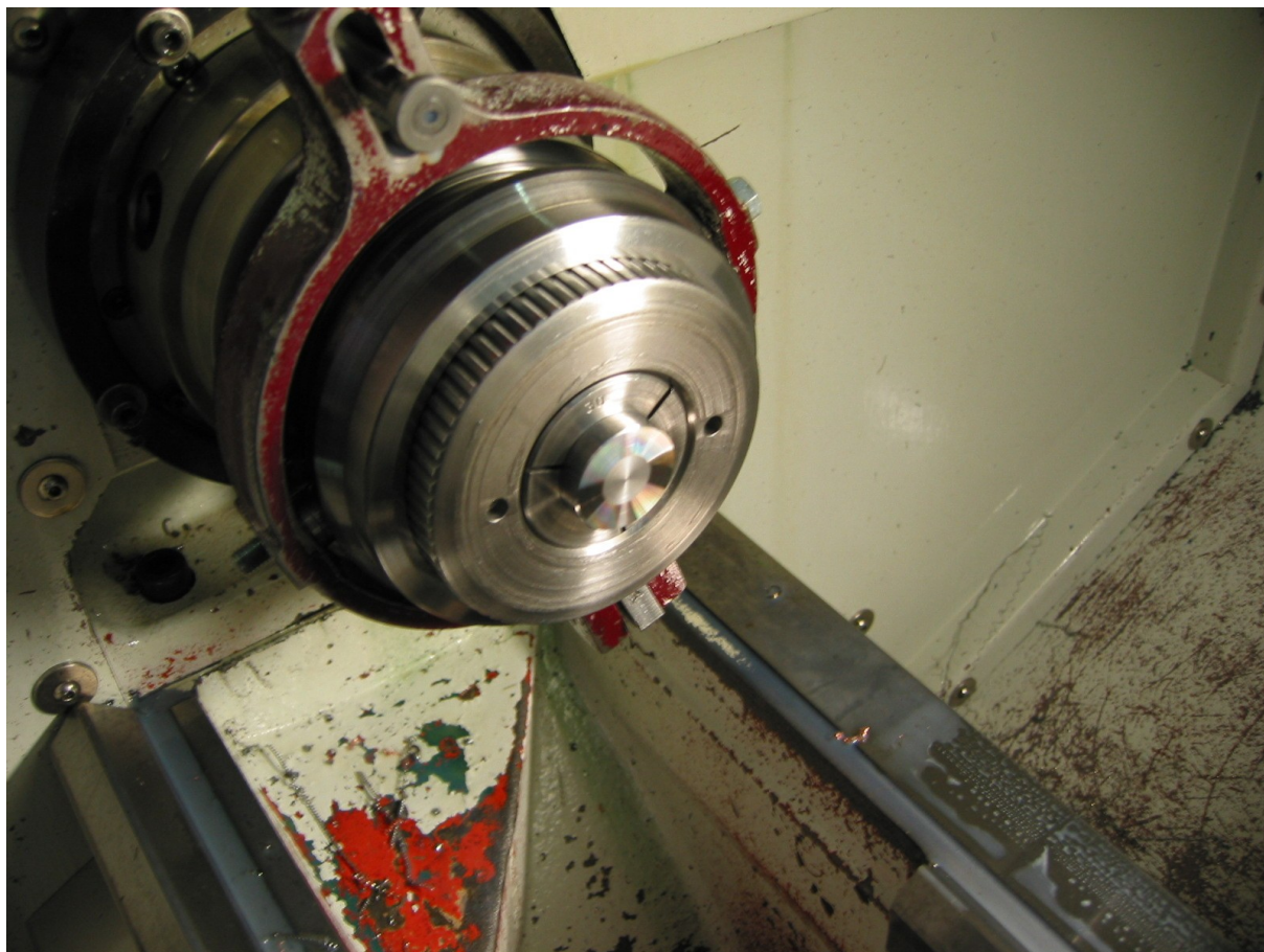
Figuur 22: het vlakgedraaide werkstuk
