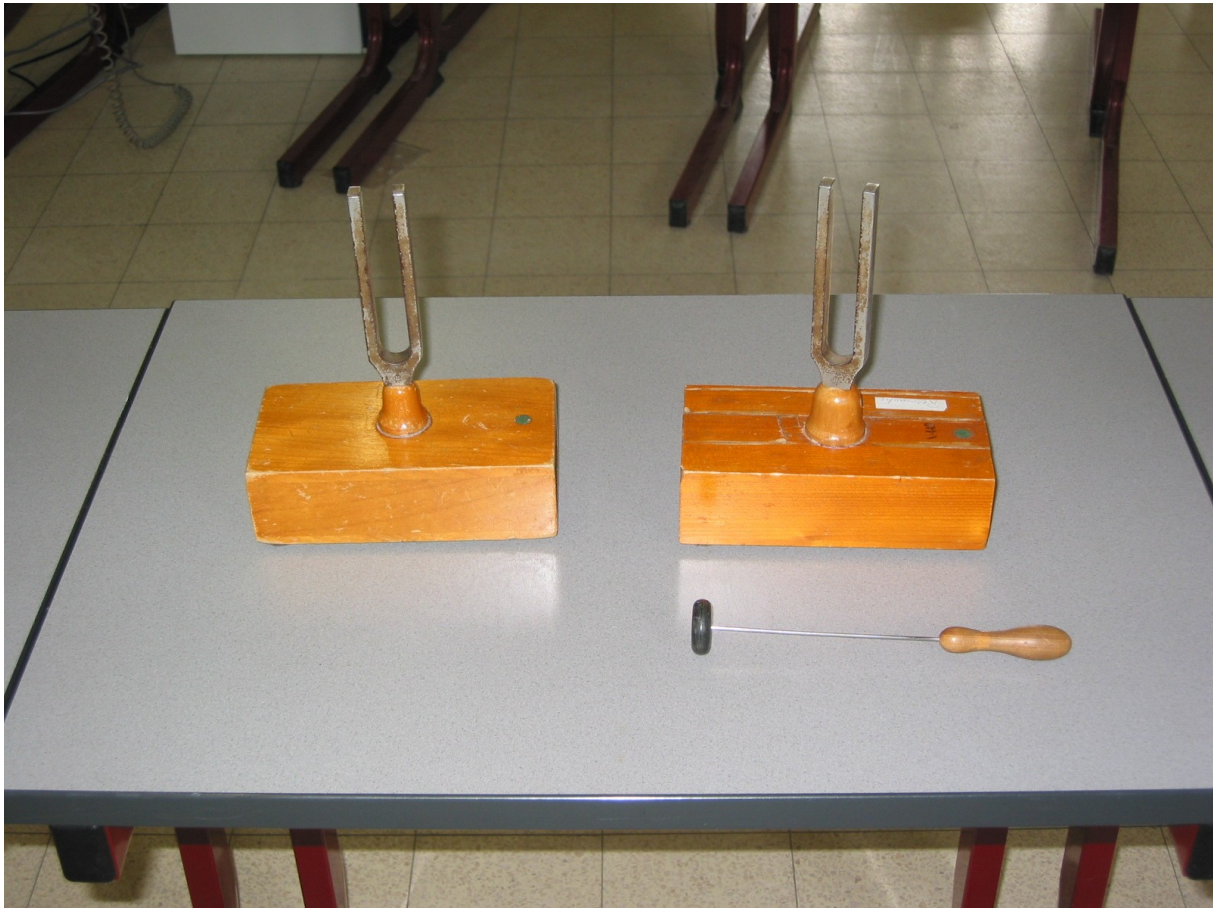
Figuur 28: 2 stemvorken die dezelfde resonantie frequentie hebben
