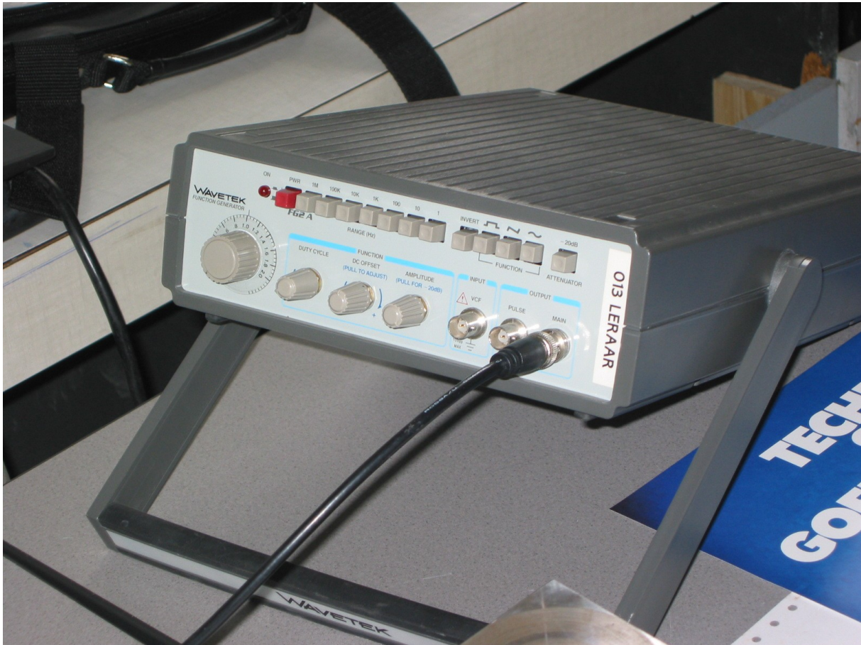
Figuur 32: frequentie generator voor de proef van Kundt
