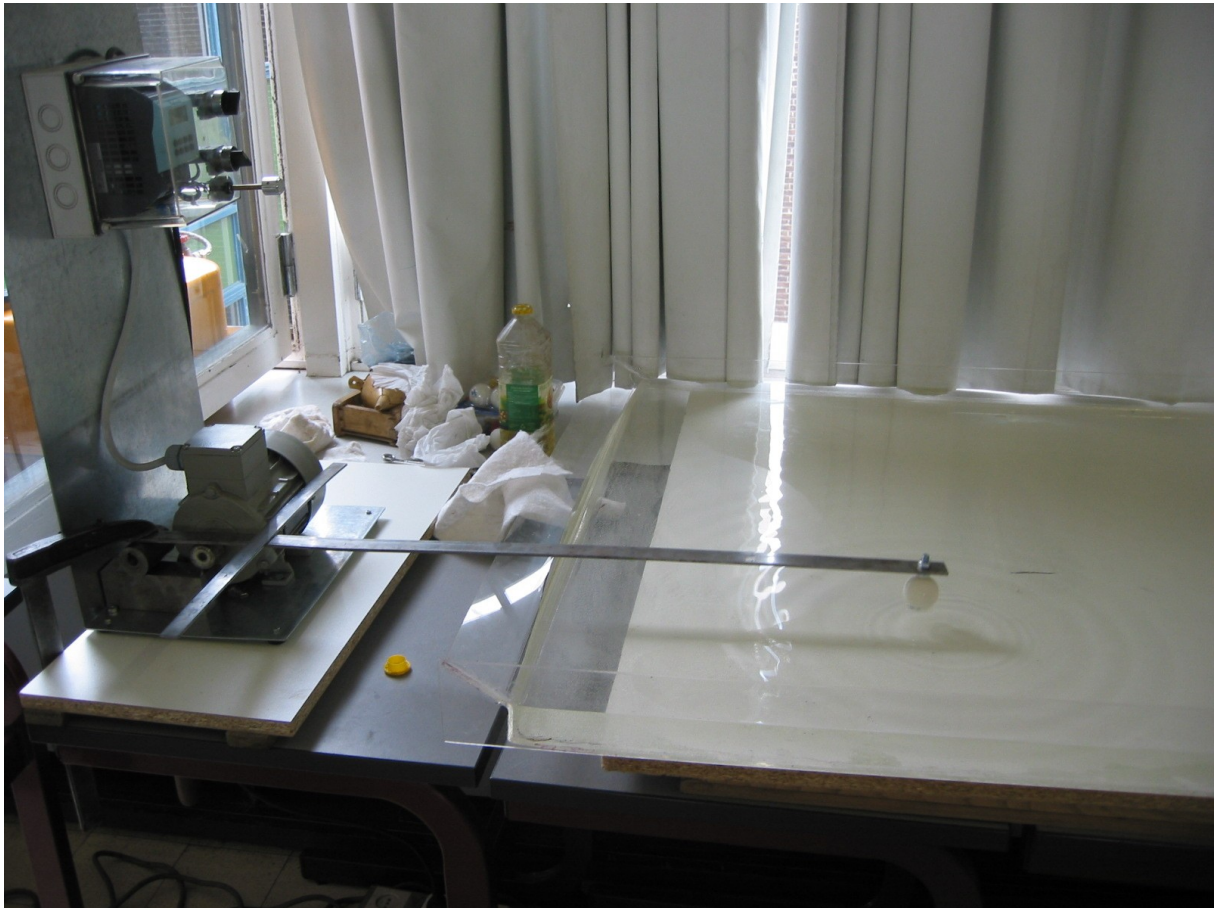
Figuur 26: opstelling rimpeltank met 1 dobber
