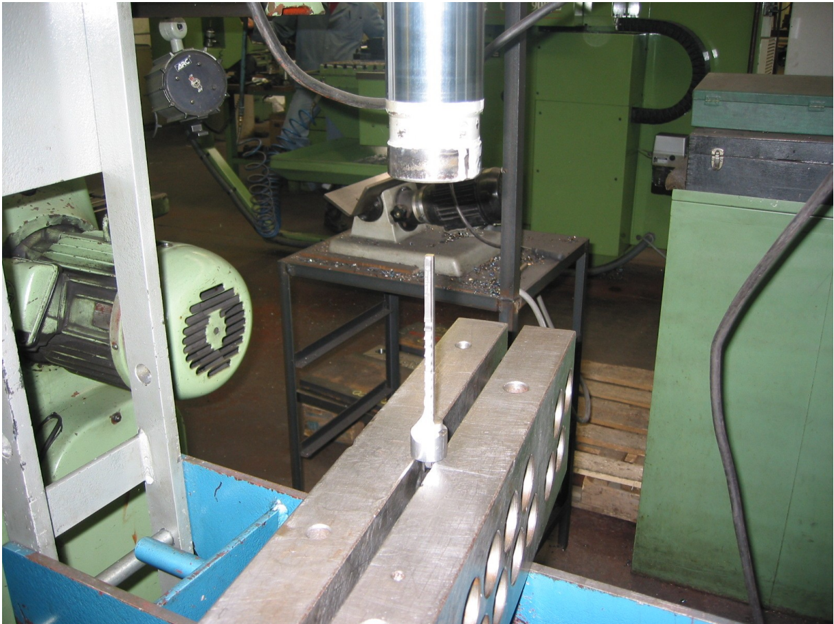
Figuur 24: opstelling om de cooter door het werkstuk te duwen
